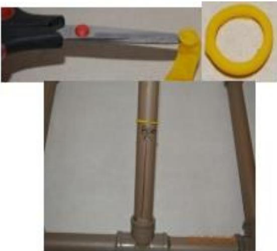
Figura 31. Fonte: MOBFOG. Anel vedação feito com balão.
