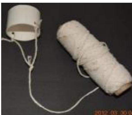
Figura 33. Fonte: MOBFOG. Modelo de gatilho feito com cano pvc de 40mm.
