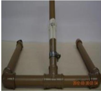
Figura 29. Fonte: MOBFOG. Modelo de gatilho feito de cano pvc enrolado com esparadrapo.
