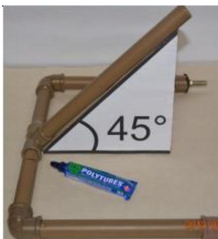
Figura 22. Fonte: MOBFOG. Base lançadora de foguete construída como cano pvc.
