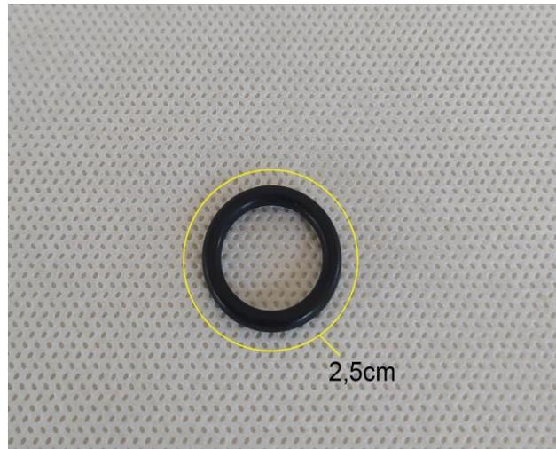
Figura 32. Fonte: Próprio autor. Modelo de um novo Anel de vedação.
