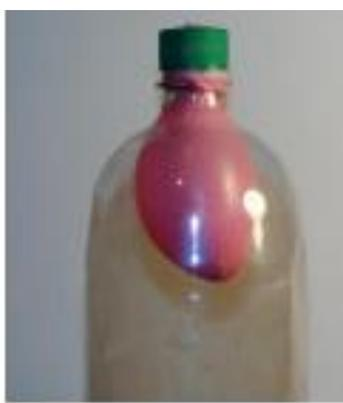
Figura 25. Fonte: MOBFOG – Figura mostrando um balão contendo água para o foguete adquirir estabilidade.
